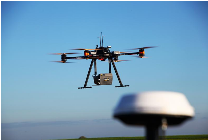
[그림 3] LiDAR센서를 장착한 무인항공기
