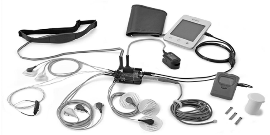
[그림 1] 바이오메트릭 센서들 - 아두이노와 라스베리파이를 위한 이헬스(e-Health) 센서 플랫폼 v2.0
