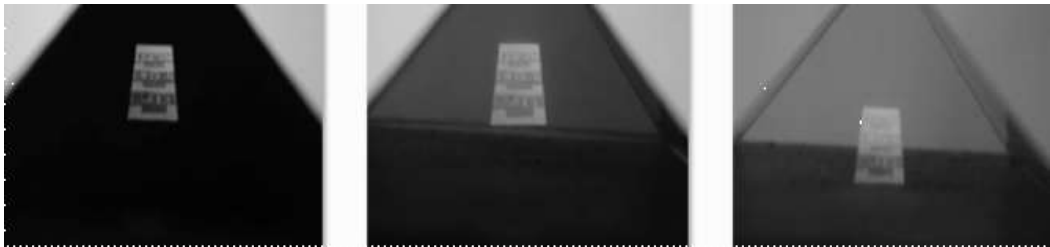
[그림7] 아크릴 재료의 투명도별 홀로그램 선명도 및 입체감 실험
