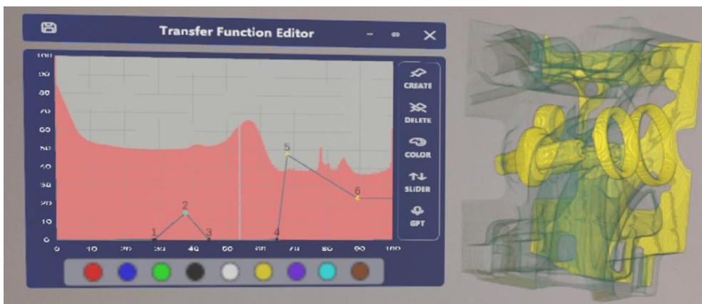
[그림 1] Engine TF editor 및 DVR 결과 [Fig. 1] Engine TF editor and DVR result
