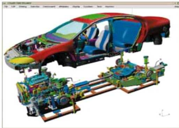
[그림 2-5] 미국 Chrysler의 Intrepid의 DMU 모델
