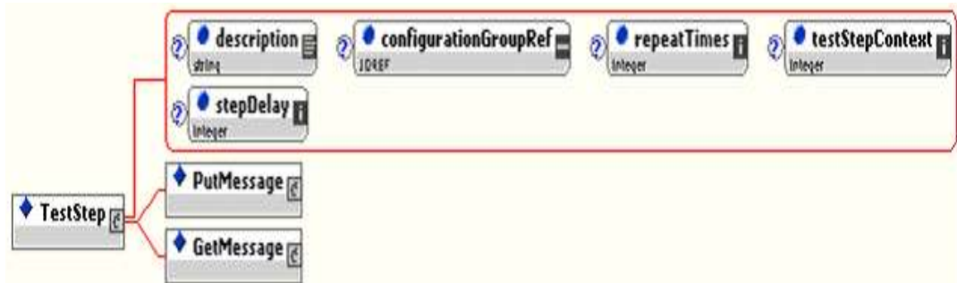
[그림 3-6] 테스트 스텝의 데이터 구조도
